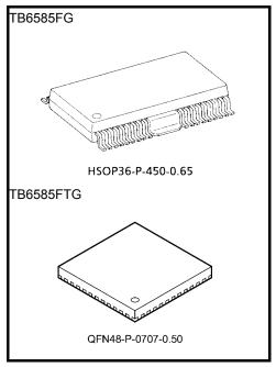
Weight: HSOP36-P-450-0.65: 0.79 g (typ.) QFN48-P-0707-0.50: 0.137 g (typ.)
